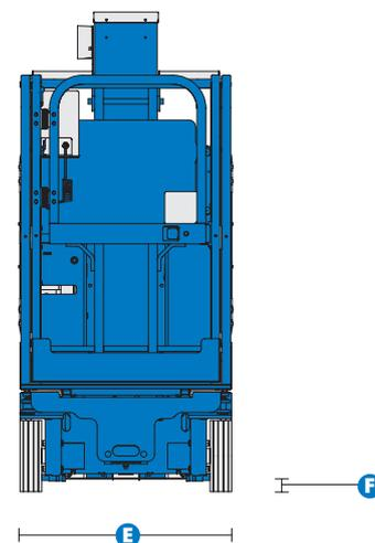
\* Altura de trabajo = Altura de la plataforma + 2 m
