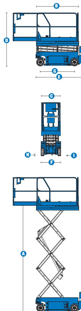
\* Altura de trabajo = Altura de la plataforma + 2 m
